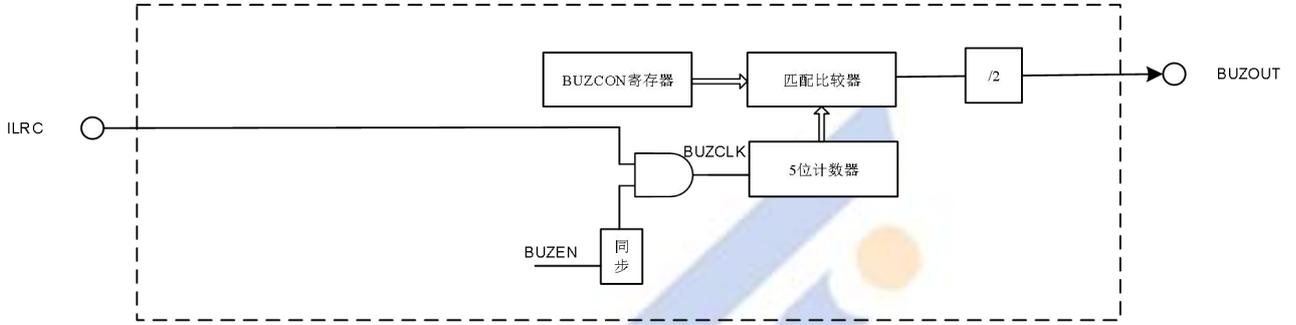
图 25- 1 BUZZER 内部框图
