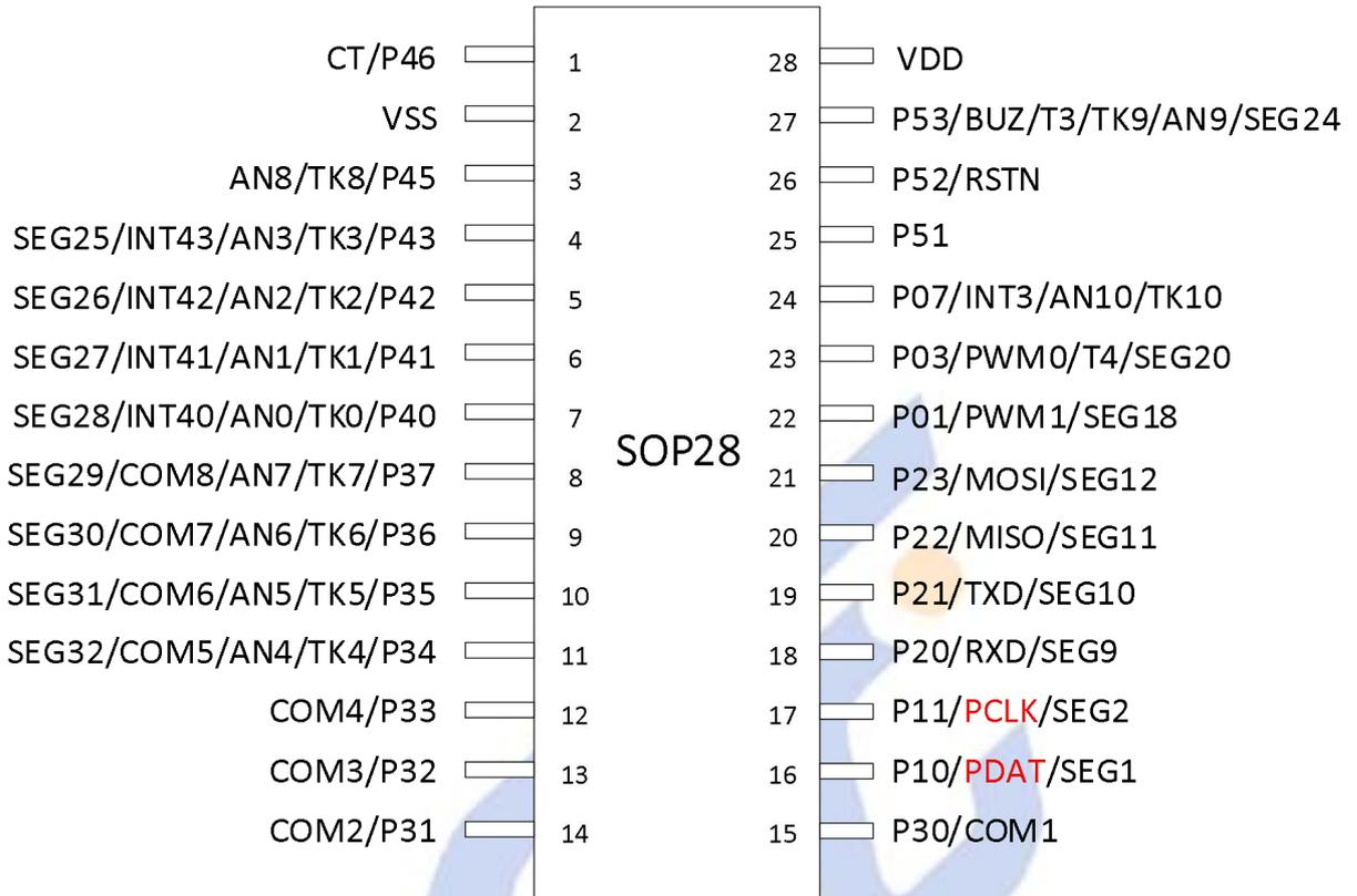
图 4- 2 SOP28 引脚图
