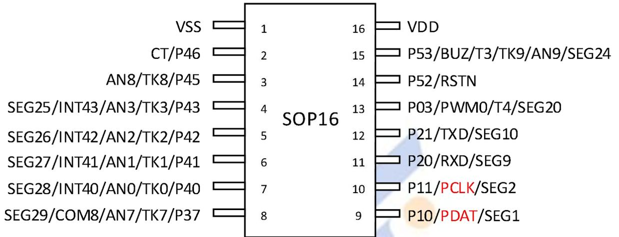
图 4-4 SOP16 引脚图
