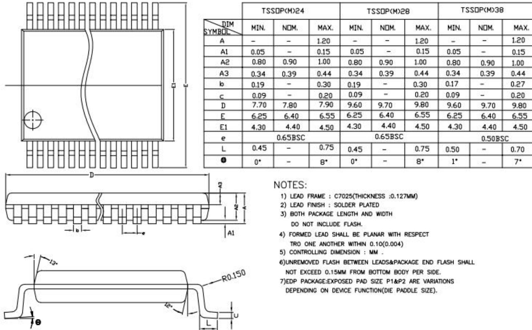
图 31- 5 TSSOP28 封装尺寸图
