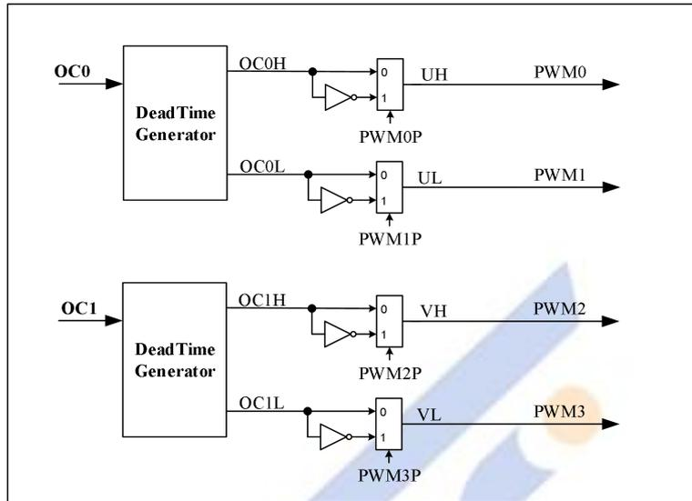
当 PWM 输出寄存器配置为使能时，输出波形可通过 PWM0H/PWM0L/PWM1H/PWM1L 输出，各个输出与外部 GPIO 的对应关系，详见 GPIO 配置及引脚布局图等相应章节。
