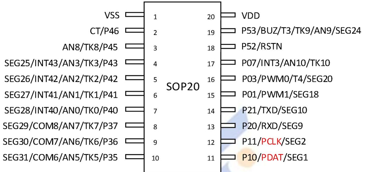
图 4- 3 SOP20 引脚图
