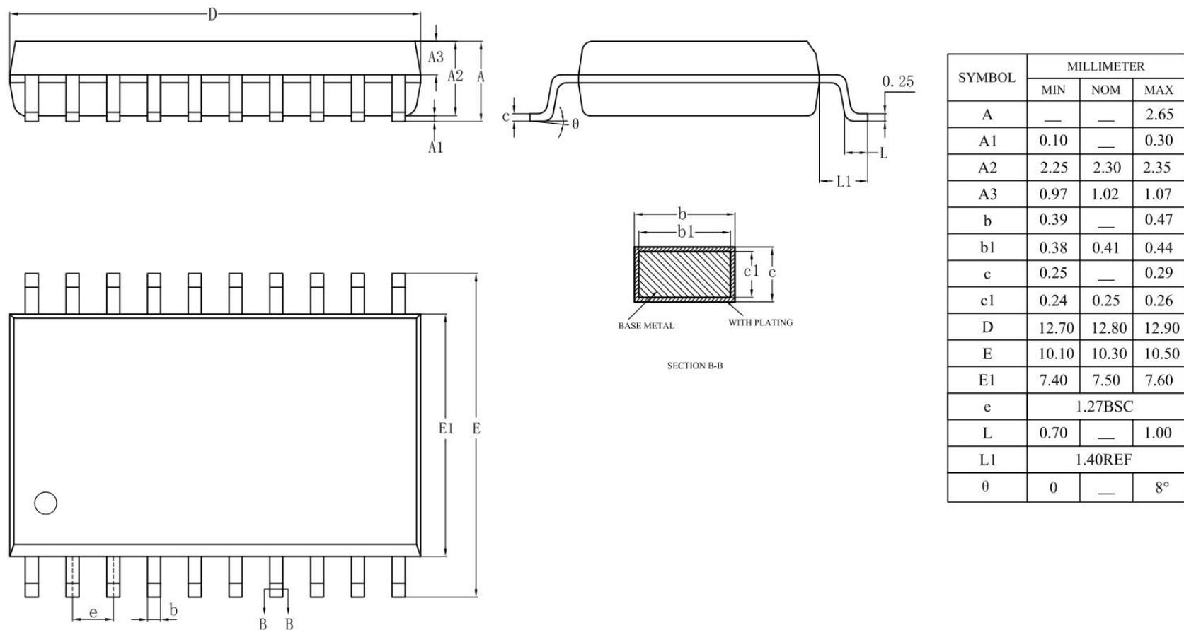
图 31- 3 SOP20 封装尺寸图
