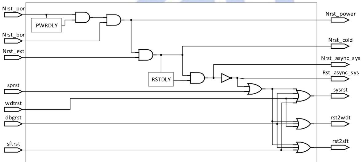
图 10- 1 复位结构内部框图
